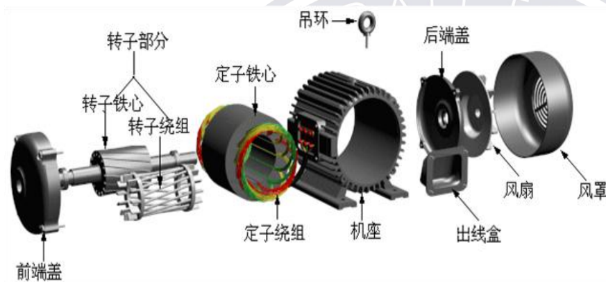
鼠笼型异步电动机主要部件拆分图
