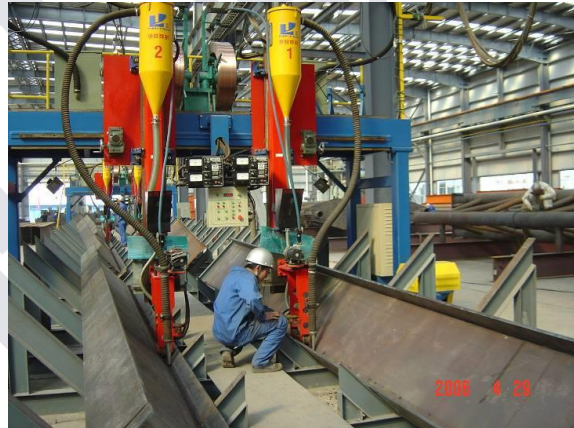
焊接 H 型钢生产线配备埋弧自动焊
